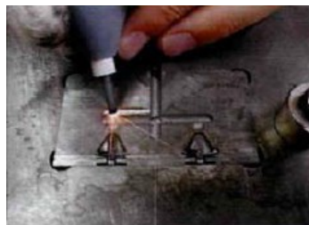
Nakładanie warstwy na formę do ciśnieniowego odlewania aluminium Coating Al-casting mold
